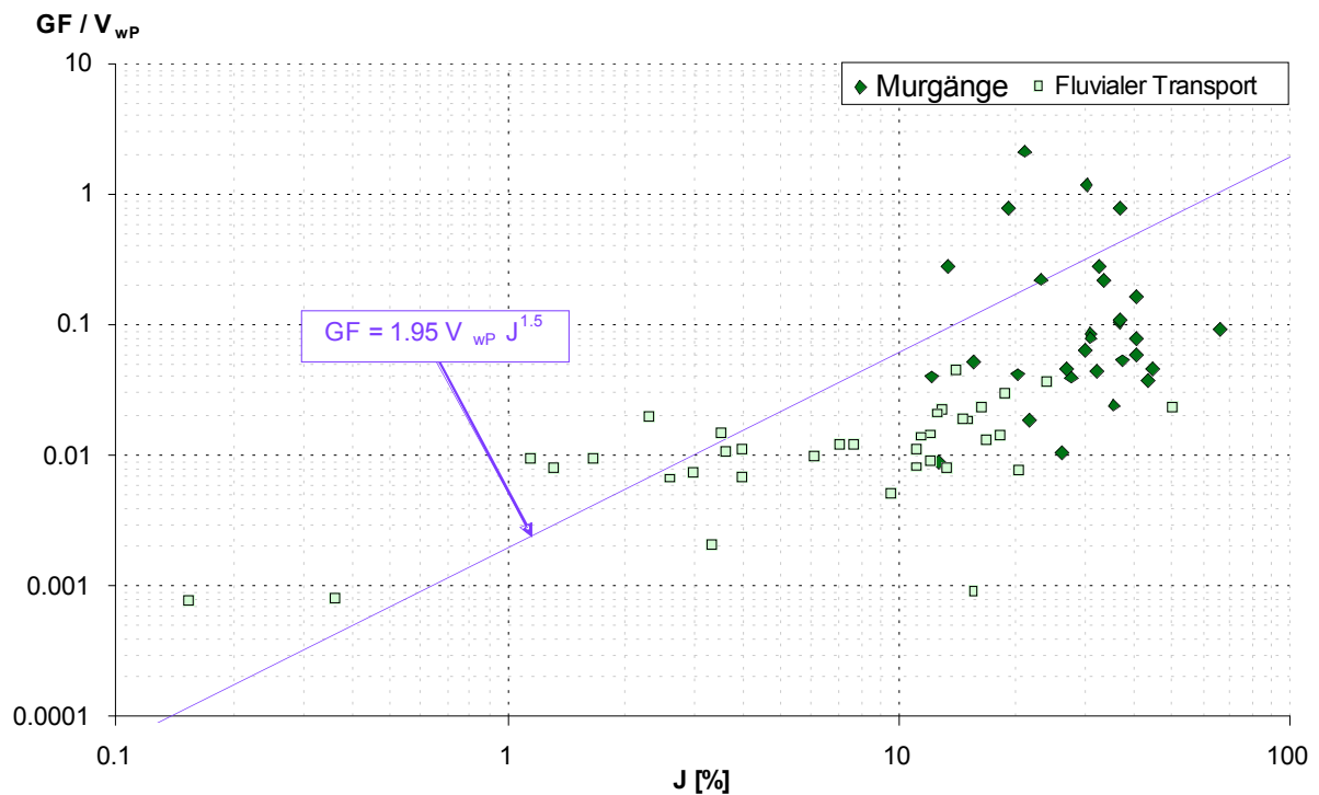
Abb. 7: Beobachtete Geschiebefrachten ( GF ), normiert mit der unteren Grenze der relevanten Abflussfracht ( V_{wp} ), in Bezug zum Gerinnegefälle in der Schlüsselstrecke ( J ), und im Vergleich mit der einfachen Geschiebetransportformel (3).
