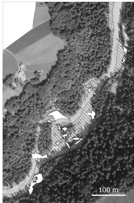
Abb. 6: Erodierte Waldflächen (schraffiert) und Ablagerung von Schwemmholz in Haufen (weiß). Fließrichtung von unten nach oben.
