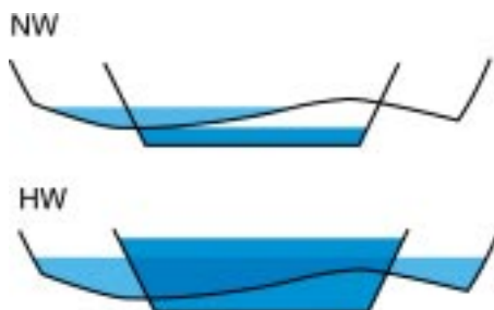
Bild 6. Wasserspiegellagen bei Niederwasser und Hochwasser in einer kanalisiertem Gerinne und in einer Aufweitung.
